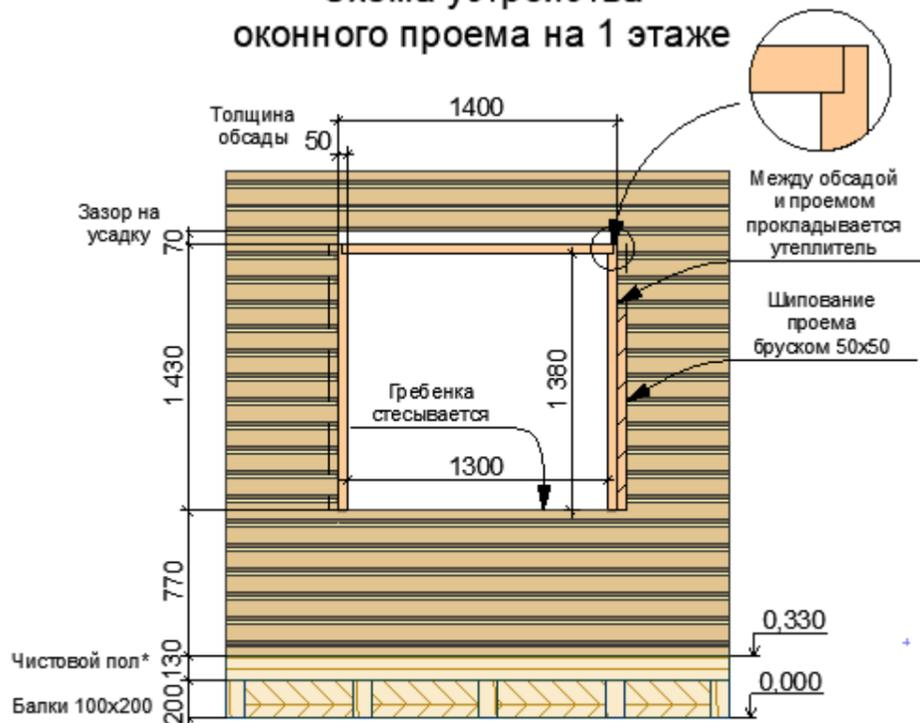
\*(5 см поперечное утепление, 4 см контрлага под коммуникации и вентзазор, 2 см фанера/гвп/цсп, 2 см ламинат/ленолеум/кварцвинил/плитка)
